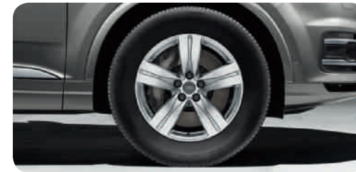
Winter-Aluminium-Schmiederäder im 5-Arm-Design Größe 8 J x 18 mit Reifen 255/60 R 18 1 , schneeketten- tauglich, zulässige Höchstgeschwindigkeit 210 km/h
