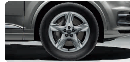
Winter-Aluminium-Gussräder im 5-Speichen-Stern-Design Größe 8 J x 19 mit Reifen 255/55 R 19 1 , schneeketten- tauglich, zulässige Höchstgeschwindigkeit 210 km/h
