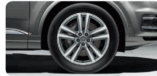
Winter-Aluminium-Gussräder im 5-Parallelspeichen-Design (S-Design) Größe 8 J x 20 mit Reifen 255/50 R 20 1 , schneeketten- tauglich, zulässige Höchstgeschwindigkeit 210 km/h
