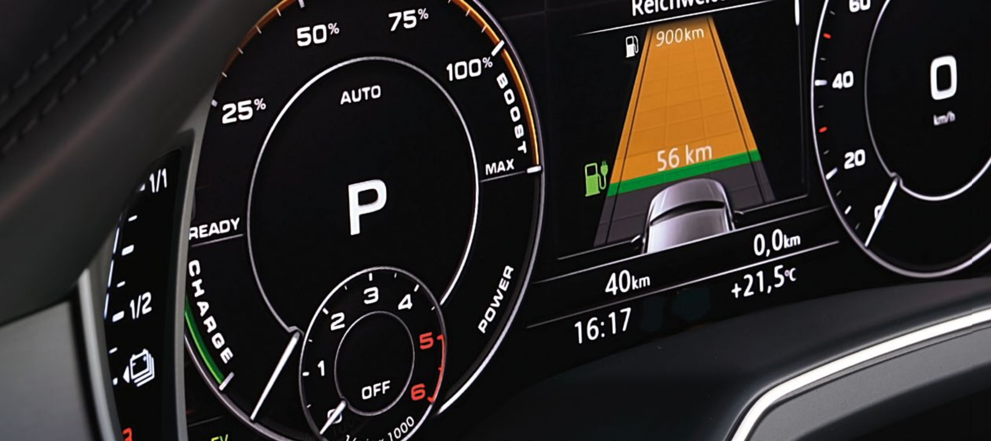
O1_Audi virtual cockpit in klassischer Darstellung mit Drehzahlmesser und Verbrauchsanzeige der letzten Fahrten O2_Audi virtual cockpit mit Navigationskarte und kleinen Rundinstrumenten
