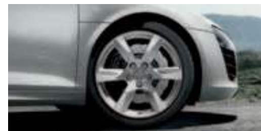
Winter-Aluminium-Gussräder im 6-Arm-Design Größe 8,5 J x 18 vorn und 10,5 J x 18 hinten, mit Winterreifen 235/40 R 18 vorn und 285/35 R 18 hinten, schneeketten- tauglich, zulässige Höchstgeschwindigkeit 240 km/h
