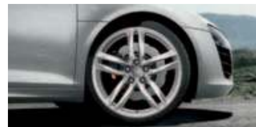
Winter-Aluminium-Schmiederäder im 5-Doppelspeichen-Design, glanzgedreht Größe 8,5 J x 19 vorn und 10,5 J x 19 hinten, mit Winterreifen 235/35 R 19 vorn und 295/30 R 19 hinten, schneeketten- tauglich, zulässige Höchstgeschwindigkeit 240 km/h
