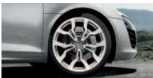
Aluminium-Schmiederäder im 10-Speichen-Y-Design, hochglanzpoliert Größe 8,5 J x 19 vorn und 11 J x 19 hinten, mit Reifen 235/35 R 19 vorn und 305/30 R 19 hinten
