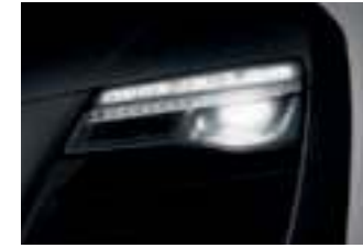
Abblendlicht aus 6 LEDs plus Abblendlichtspot
