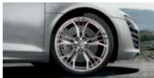
Aluminium-Schmiederäder im 5-Doppelspeichen-Y-Design Größe 8,5 J x 19 vorn und 11 J x 19 hinten, mit Reifen 235/35 R 19 vorn und 295/30 R 19 hinten
