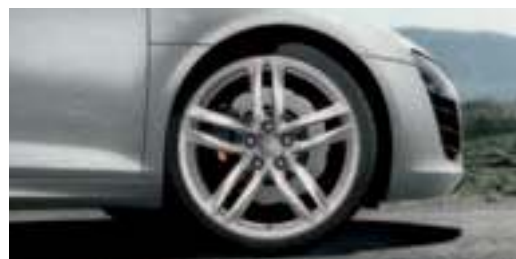
Aluminium-Schmiederäder im 5-Doppelspeichen-Design, glanzgedreht Größe 8,5 J x 19 vorn und 11 J x 19 hinten, mit Reifen 235/35 R 19 vorn und 295/30 R 19 hinten
