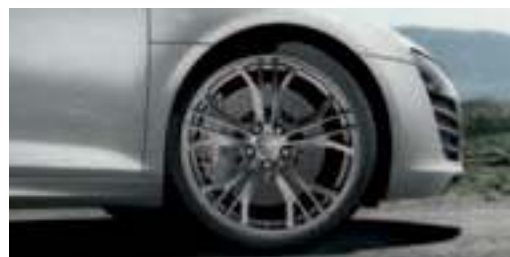
Aluminium-Schmiederäder im 5-Doppelspeichen-Y-Design in Titanoptik Größe 8,5 J x 19 vorn und 11 J x 19 hinten, mit Reifen 235/35 R 19 vorn und 305/30 R 19 hinten
