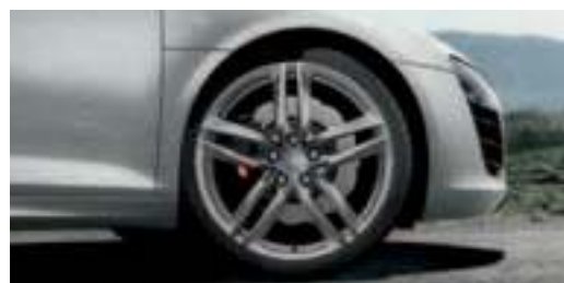
Aluminium-Schmiederäder im 5-Doppelspeichen-Design in Titanoptik Größe 8,5 J x 19 vorn und 11 J x 19 hinten, mit Reifen 235/35 R 19 vorn und 305/30 R 19 hinten
