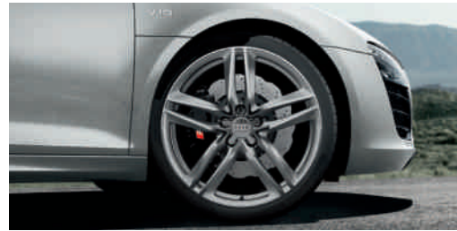
Aluminium-Schmiederäder im 5-Doppelspeichen-Design in Titanoptik matt Größe 8,5 J x 19 vorn und 11 J x 19 hinten, mit Reifen 235/35 R 19* vorn und 305/30 R 19* hinten
