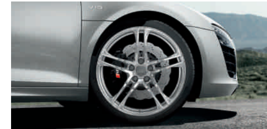
Winter-Aluminium-Schmiederäder im 5-Doppelspeichen-Design Größe 8,5 J x 19 vorn und 10,5 J x 19 hinten, mit Winterreifen 235/35 R 19* vorn und 295/30 R 19* hinten, schneekettentauglich, zulässige Höchst- geschwindigkeit 240 km/h
