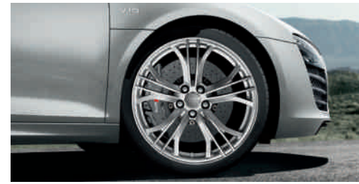
Aluminium-Schmiederäder im 5-Doppelspeichen-Y-Design Größe 8,5 J x 19 vorn und 11 J x 19 hinten, mit Reifen 235/35 R 19* vorn und 295/30 R 19* hinten
