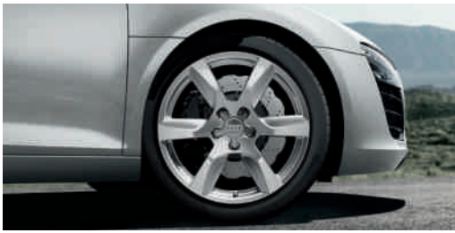
Aluminium-Gussräder im 6-Arm-Design Größe 8,5 J x 18 vorn und 10,5 J x 18 hinten, mit Reifen 235/40 R 18* vorn und 285/35 R 18* hinten
