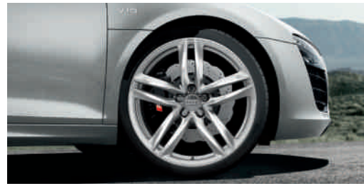
Aluminium-Schmiederäder im 5-Doppelspeichen-Design, glanzgedreht Größe 8,5 J x 19 vorn und 11 J x 19 hinten, mit Reifen 235/35 R 19* vorn und 295/30 R 19* hinten
