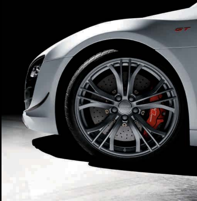
□ Aluminium-Schmiederäder im 5-Doppelspeichen-Y-Design in Titanoptik Größe 8,5 J x 19 vorn, Größe 11 J x 19 hinten, mit Reifen 235/35 R 19 vorn und 295/30 R 19 hinten
