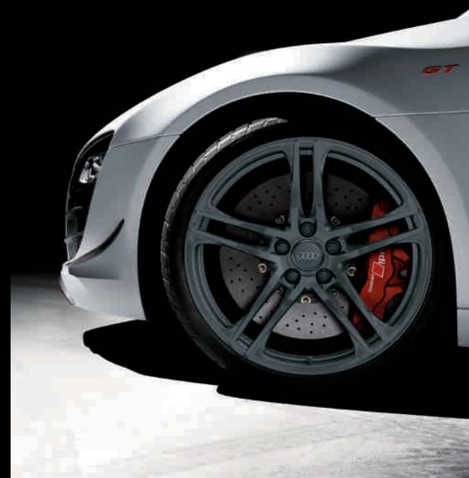
■ Aluminium-Schmiederäder Audi exclusive im 5-Doppelspeichen-Design in Titanoptik Größe 8,5 J x 19 vorn, Größe 11 J x 19 hinten, mit Reifen 235/35 R 19 vorn und 305/30 R 19 hinten. Ein Angebot der quattro GmbH
