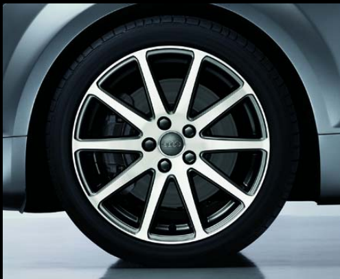
Aluminium-Gussräder im 10-Speichen-Design, Größe 9 J x 18 mit Reifen 245/40 R 18, poliert, zweifarbig
