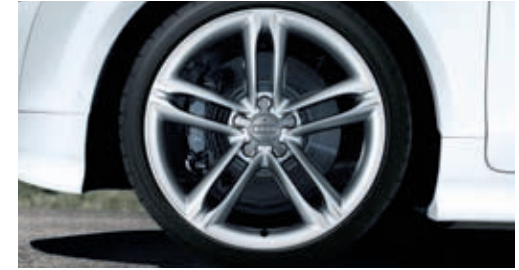
Aluminium-Gussräder Audi exclusive im 5-Parallelspeichen-Stern-Design Größe 9 J x 19 mit Reifen 255/35 R 19. Ein Angebot der quattro GmbH
