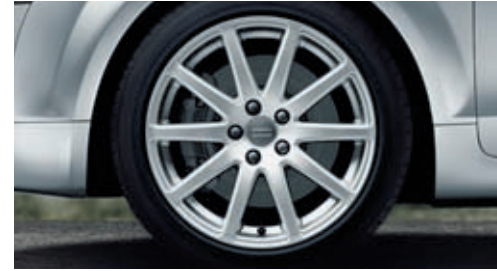
Winter-Aluminium-Gussräder im 10-Speichen-Design Größe 9 J x 18 mit Reifen 245/40 R 18, nicht schneekettentauglich, zulässige Höchstgeschwindigkeit 240 km/h, wahlweise mit Reifen mit Notlaufeigenschaften
