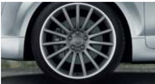
Aluminium-Gussräder Audi exclusive im 15-Speichen-Design in Titanoptik matt, glanzgedreht Größe 9 J x 19 mit Reifen 255/35 R 19*. Ein Angebot der quattro GmbH
