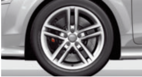
Aluminium-Gussräder im 5-Doppelspeichen-Design Größe 9 J x 18 mit Reifen 245/40 R 18*
