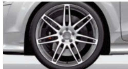
Aluminium-Schmiederäder im 7-Doppelspeichen-Design, poliert, 2-farbig Größe 9 J x 20 mit Reifen 255/30 R 20*
