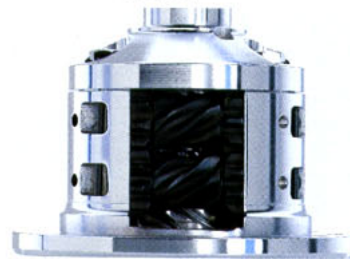
Das Torsen-Zwischendifferential regelt die Kraftverteilung automatisch und variabel.
