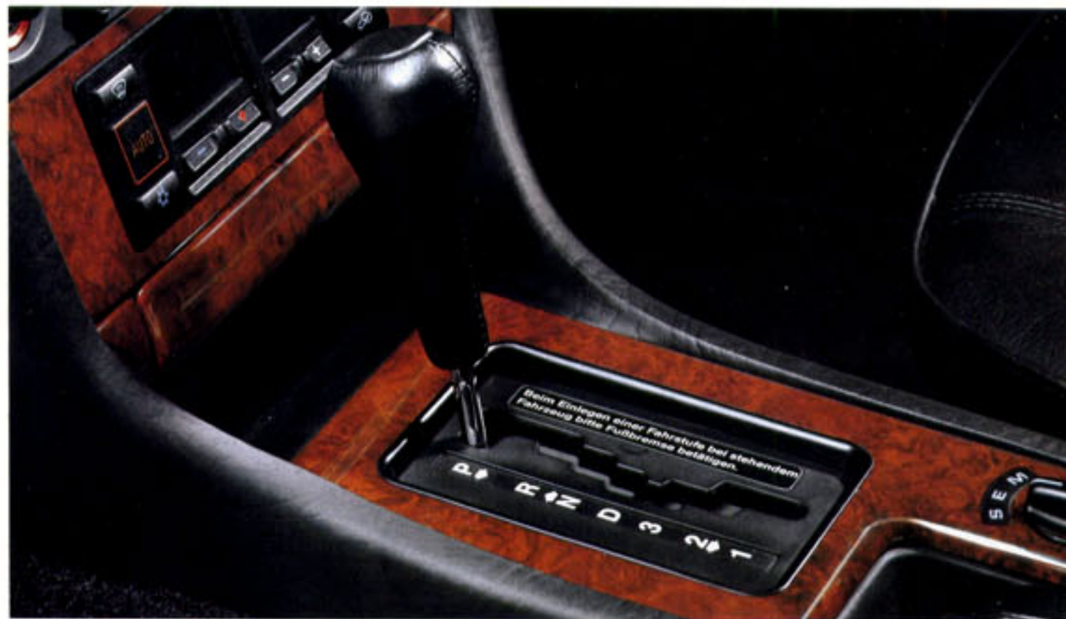
Das 4-Gang-Automaticgetriebe mit 3 Fahrprogrammen.
