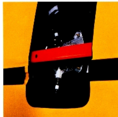
Durch hochfeste Strangpressprofile in den Türen kann in bestimmten Unfallsituationen die Türverformung erheblich reduziert werden.
