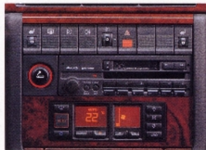
Die elektronisch gesteuerte Klimaautomatik mit Umluft- und Stauluftregelung sorgt für ein angenehmes Innenraumklima.
