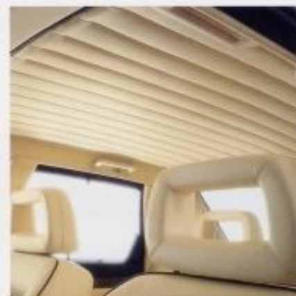
Der längegestepte Dachhimmel.
