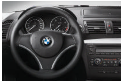
□ Sport-Lederlenkrad (Durchmesser 369 mm), mit Daumenauflagen (in Verbindung mit Schaltwippen am Lenkrad ohne Daumenauflagen), Chromspange, drei Speichen (Serie für 130i und 123d).
