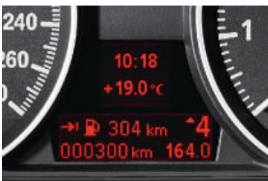
■ Bordcomputer informiert über Durchschnittsgeschwindigkeit, Durchschnitts- und Momentanverbrauch, Reichweite und Außentemperatur.
