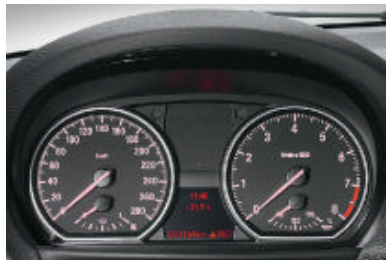
■ Instrumententafel mit Analoginstrumenten und roter Durchlichtbeleuchtung, Tacho mit LC-Display für Kilometer- und Tageskilometerzähler sowie Bordcomputer, Drehzahlmesser mit integrierter Tankuhr.
