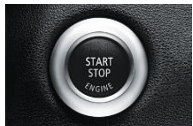
■ Start-/Stop-Knopf zum Starten des Motors. Der Zündschlüssel wird eingesteckt, und der Motor kann per Knopfdruck gestartet bzw. gestoppt werden. □ Komfortzugang ermöglicht das Öffnen und Schließen des Fahrzeugs, ohne die Fernbedienung in die Hand zu nehmen. Der Motor kann zudem schlüssellos gestartet werden.
