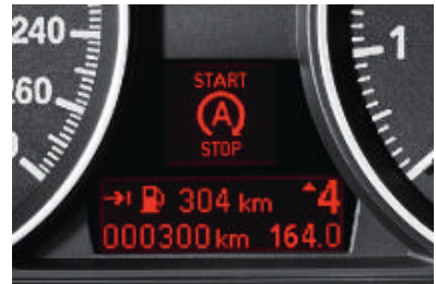
■ Auto Start Stop Anzeige (für alle Vierzylinder-Modelle in Verbindung mit 6-Gang Schaltgetriebe) signalisiert im Info Display, wenn der Motor über die Auto Start Stop Funktion abgeschaltet ist (z. B. vor einer Ampel oder bei einem Stau). Die Anzeige erlischt wieder beim erneuten automatischen Starten des Motors.
