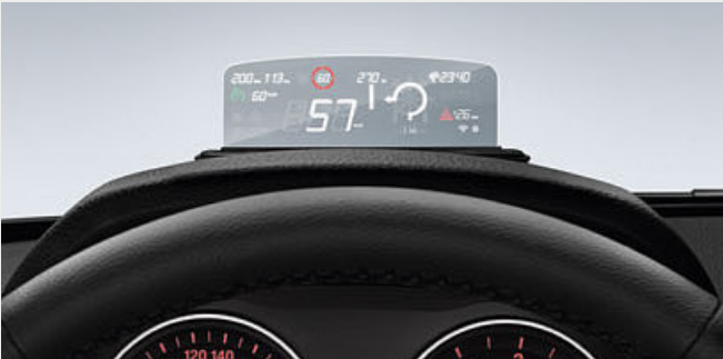
○ Der BMW Head-Up Screen rückt Fahrzeug- sowie Navigationsinformationen ins Sichtfeld des Fahrers – in Verbindung mit einer Smartphone-Schnittstelle.
