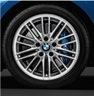
□ 17" M Leichtmetallräder Doppelspeiche 460 M mit Mischbereifung, Größe vorn 7,5J x 17, Bereifung 225/45 R17, Größe hinten 8J x 17, Bereifung 245/40 R17. 4
