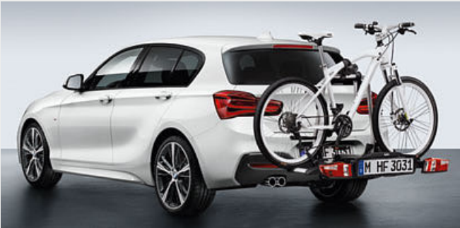
○ Leichter, stabiler Fahrradheckträger für zwei Fahrräder/E-Bikes (auf drei Räder erweiterbar). Mit bis zu 60 kg belastbar und kompakt zusammenfaltbar.
