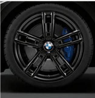
□ 18" M Leichtmetallräder Doppelspeiche 719 M Jetblack 1 mit Mischbereifung, Radgröße vorn 7,5J x 18, Bereifung 225/40 R18, Radgröße hinten 8J x 18, Bereifung 245/35 R18.
