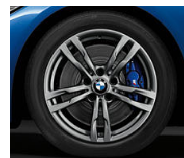
□ 18" M Leichtmetallräder Doppelspeiche 441 M in Ferricgrey mit Mischbereifung, Größe vorn 8 J x 18, Bereifung 225/45 R 18, Größe hinten 8,5 J x 18, Bereifung 255/40 R 18.
