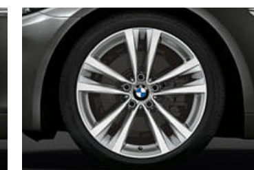
□ 19" Leichtmetallräder Doppelspeiche 610 in Bicolor mit Mischbereifung und Notlaufeigenschaften. Größe vorn 8,5 J x 19, Bereifung 245/40 R 19, hinten 9 J x 19, Bereifung 275/35 R 19.
