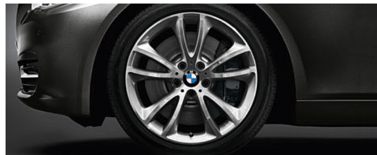
□ 19" Leichtmetallräder V-Speiche 366 mit Mischbereifung und Notlaufeigenschaften. Größe vorn 8,5 J x 19, Bereifung 245/40 R 19, Größe hinten 9 J x 19, Bereifung 275/35 R 19.
