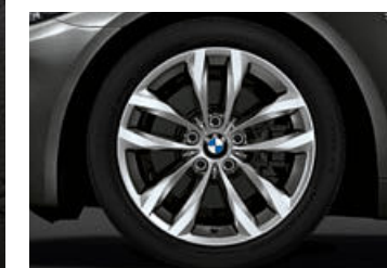
■ 18" Leichtmetallräder Doppelspeiche 609 mit Mischbereifung und Notlaufeigenschaften. Größe vorn 8 J x 18, Bereifung 245/45 R 18, hinten 9 J x 18, Bereifung 275/40 R 18.
