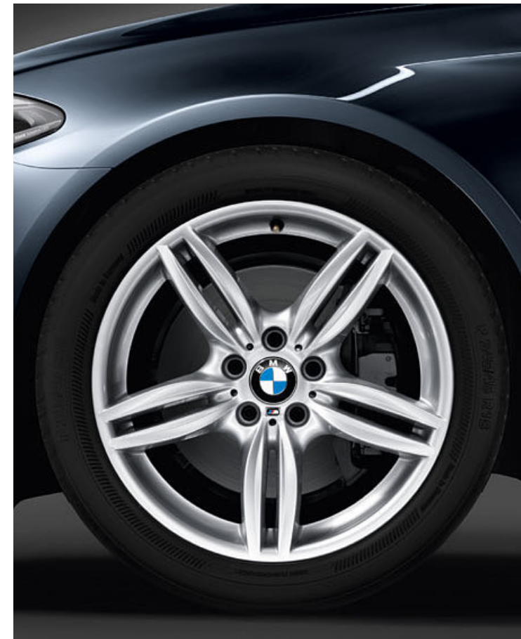
□ 19" Leichtmetallräder Doppelspeiche 351 M mit Mischbereifung und Notlaufeigenschaften. Größe vorn 8,5 J x 19, Bereifung 245/40 R 19, Größe hinten 9 J x 19, Bereifung 275/35 R 19. (Serie für M550d xDrive).
