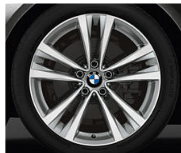
□ 19" Leichtmetallräder Doppelspeiche 610 in Bicolor mit Mischbereifung und Notlaufeigenschaften. Größe vorn 8,5 J x 19, Bereifung 245/40 R 19, hinten 9 J x 19, Bereifung 275/35 R 19.
