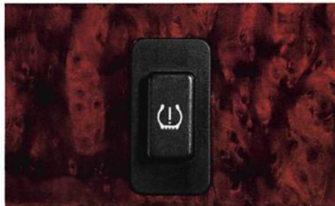
□ Reifen Druck Control (RDC) überwacht sensorgesteuert den Luftdruck in den Reifen. Leichten Druckabfall signalisiert eine Leuchte in der Instrumententafel, starken Druckabfall zusätzlich eine akustische Warnung.
