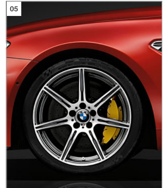
[ 05 ] 20" M Leichtmetallräder Doppelspeiche 601 M (optional), Bicolor-Ausführung, glanzgedreht, mit Mischbereifung, Größe vorn 9,5 J x 20, Bereifung 265/35 R 20, Größe hinten 10,5 J x 20, Bereifung 295/30 R 20. 2
