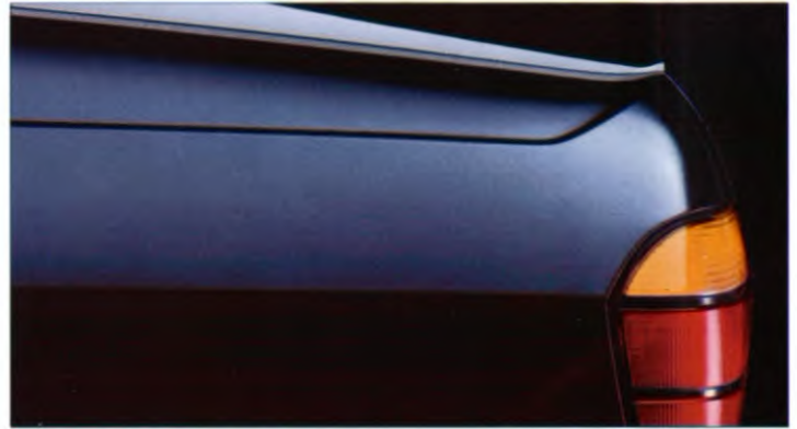
Ein ästhetisches Detail mit purer Funktionalität. Der integrierte Heckspoiler minimiert den Auftrieb an der Hinterachse und sorgt so für besseren Geradeauslauf.
