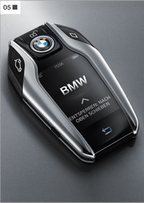
[ 05 ] Der BMW Display Schlüssel zeigt diverse Statusdaten des Fahrzeugs und erlaubt die Bedienung ausgewählter Funktionen per integriertem Touch-Display.
