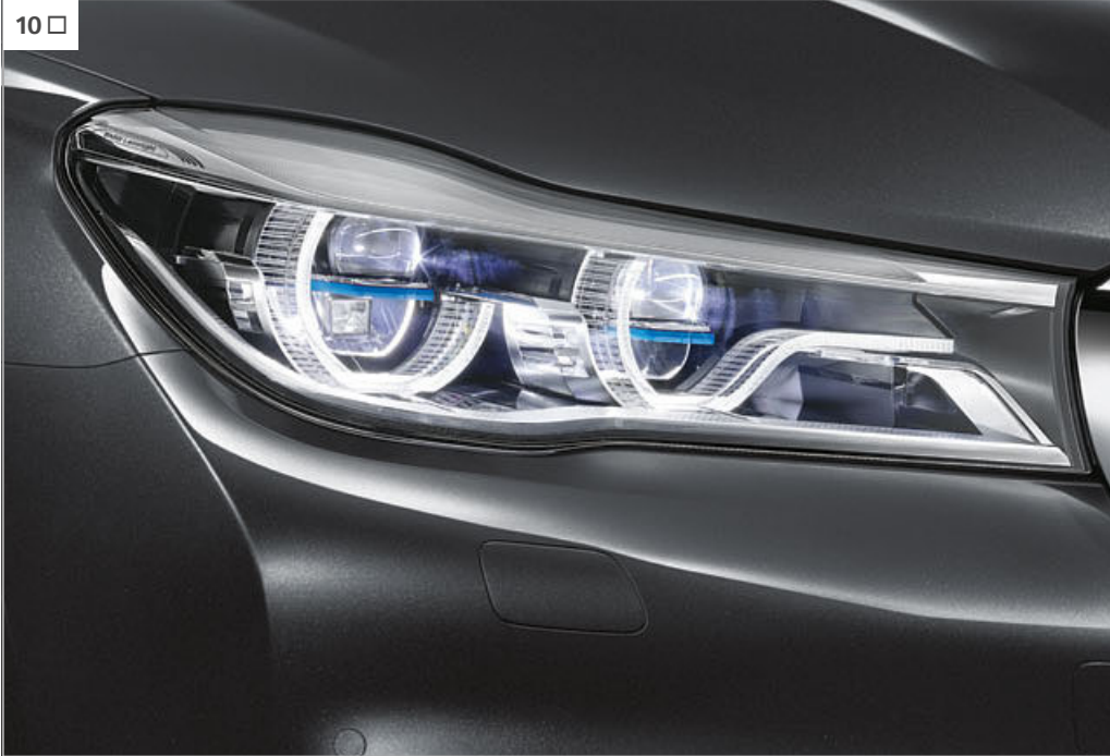
[ 08 ] Der Adaptive LED-Scheinwerfer inkl. Kurvenlicht und BMW Selective Beam (blendfreier Fernlichtassistent) bietet in jeder Fahrsituation eine wesentlich bessere Ausleuchtung und Sicht als herkömmliche Systeme.
