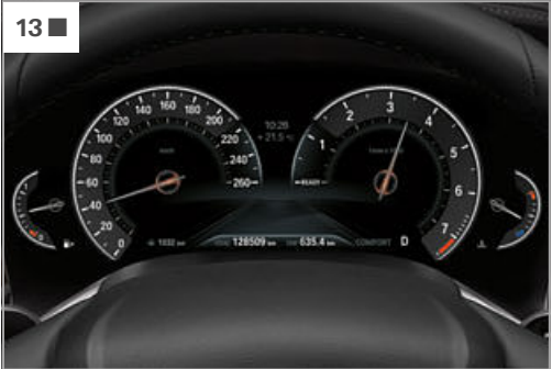
[ 12 ] Das Multifunktionale Instrumentendisplay mit 12,3" Farbdisplay in Black-Panel-Technologie bietet eine eindrucksvolle visuelle Inszenierung der Anzeigen und Instrumente.
