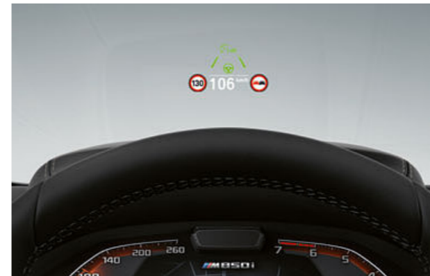
DAS BMW HEAD-UP DISPLAY 1 PROJIZIERT FAHRRELEVANTE INFORMATIONEN ABLENKUNGSFREI INS SICHTFELD DES FAHRERS.
