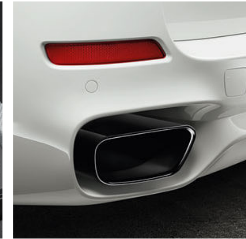
Abgasendrohr. Die trapezförmigen Endrohre links und rechts sind mit einer schwarzen Chromblende eingefasst.
