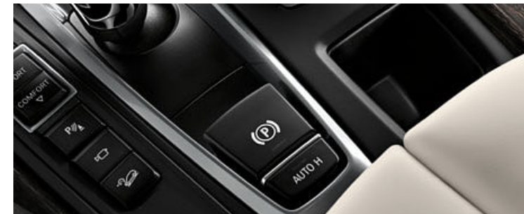
■ Parkbremse mit Automatic Hold Funktion lässt sich komfortabel über einen Taster in der Mittelkonsole aktivieren. Das Lösen der Bremse erfolgt mit Treten des Gaspedals. Die Automatic Hold Funktion unterstützt den Fahrer beispielsweise im Stop-and-Go-Verkehr oder beim Anfahren an Steigungen, indem sie nach dem Stillstand des Fahrzeugs ein ungewolltes Vor- oder Zurückrollen verhindert.
