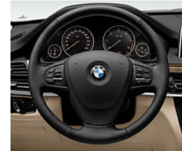
■ Lederlenkrad mit Multifunktion für Geschwindigkeitsregelung und Fernbedienung für Radio bzw. Telefon.
