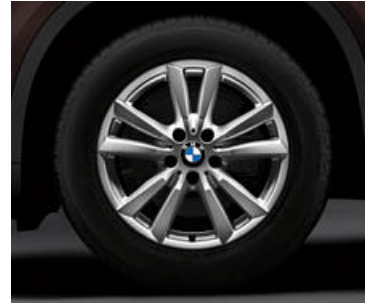
■ 18" Leichtmetallräder Doppelspeiche 446 , 8,5 J x 18, Bereifung 255/55 R 18.
