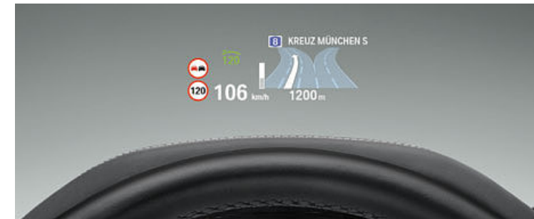
□ Das vollfarbige BMW Head-Up Display 3 blendet per optischer Projektion für die Fahrt relevante Daten in das Sichtfeld des Fahrers ein und steigert damit die Konzentration auf das Fahrgeschehen. Unter anderem werden die aktuelle Geschwindigkeit, Navigationshinweise, die Speed Limit Info inkl. Überholverbotsanzeige und Telefon- und Entertainmentlisten angezeigt.
