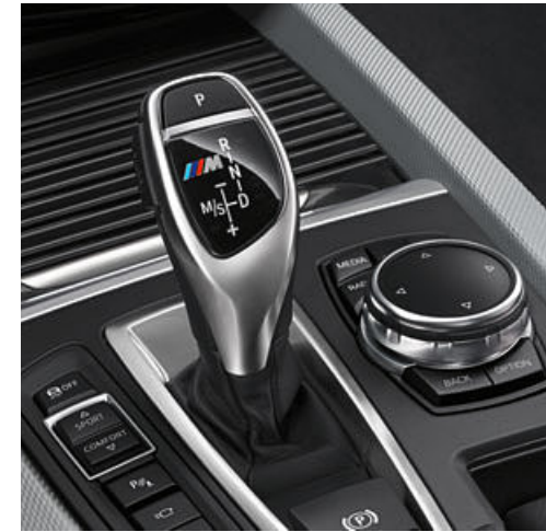
8-Gang Steptronic Sport Getriebe. Der Gangwahlschalter mit M Logo.
