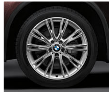
□ 20" BMW Individual Leichtmetallräder V-Speiche 551 I mit Mischbereifung, Größe vorn 10 J x 20, Bereifung 275/40 R 20, Größe hinten 11 J x 20, Bereifung 315/35 R 20.
