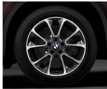
□ 19" Leichtmetallräder Sternspeiche 449 , 9 J x 19, Bereifung 255/50 R 19. Besonders empfohlen in Verbindung mit Design Pure Experience.
