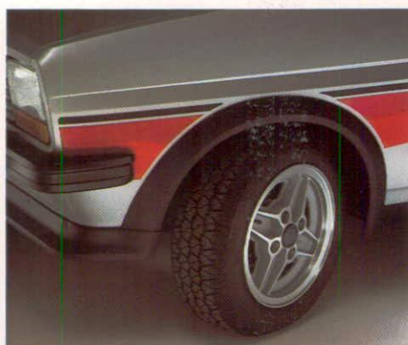
Breite 185/60 HR Stahl-Gürtelreifen auf sportlichen 6-Zoll-Alufelgen.
