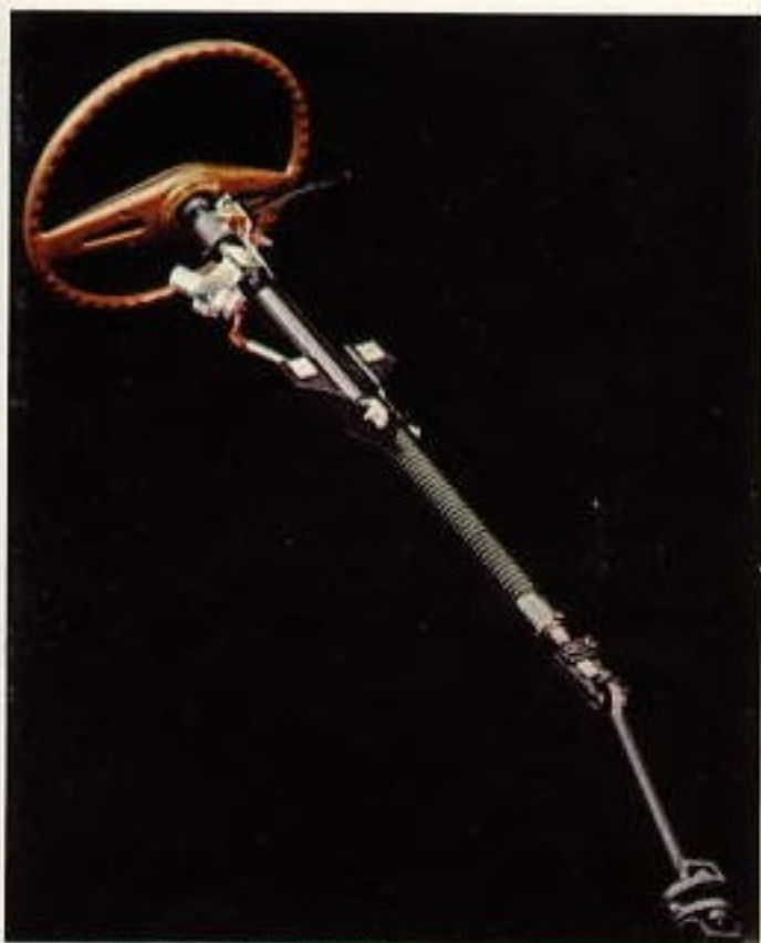
Die zweiteilige Sicherheits-Lenksäule.
