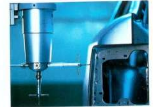
Unbestechlich: Der computergesteuerte Meßkopf prüft die Paßgenauigkeit der einzelnen Bauteile, auch im Karosseriebereich.
