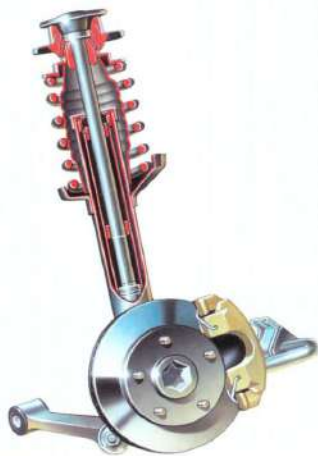
Sportlich und dennoch ausgelegt für hohen Fahrkomfort: die serienmäßigen Gasdruckstoßdämpfer.
