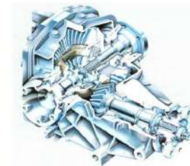
Hinterachs-Sperrdifferential mit Viscokupplung.
