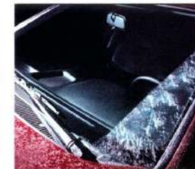
Die elektrisch beheizbare „Quickclear“-Windschutzscheibe und die beheizbaren Scheibenwäscher sorgen schnell für gute Sicht. Serienmäßig bei den GLX 4x4- und Ghia- sowie den 24V-Modellen.
