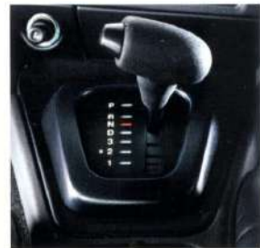
Das Viergang-Automatikgetriebe serienmäßig mit 24V-Motor.
