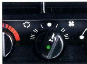
Ein angenehmes Innenraumklima zu jeder Jahreszeit durch die Ford-Klimaanlage. Einfache Bedienung, keine Zugluft, angenehme 25% Luftfeuchtigkeit. Reinigt die Außenluft von Pollen und Staub. Kein Eindringen von Abgasen bei Umluftbetrieb. Bei Regen, Schnee, Schwüle, Nebel oder Tau ist Einschalten empfehlenswert. Verfügbar ab GLX, außer in Verbindung mit Turbodiesel.
