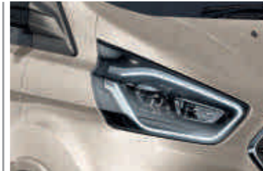
Xenon-Scheinwerfer mit dynamischem Kurvenlicht, LED-Tagfahrlicht und Nebelscheinwerfern
