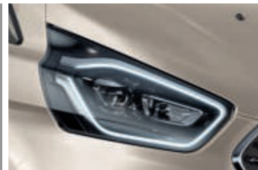
Bi-Xenon-Scheinwerfer mit statischem Kurvenlicht, LED-Tagfahrlicht und Nebelscheinwerfern
