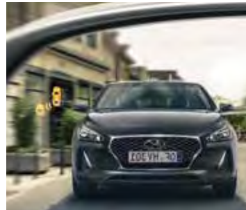
Totwinkel-Assistent 1 : Gibt visuelle und akustische Warnhinweise, wenn ein Fahrzeug im toten Winkel erkannt wird.
