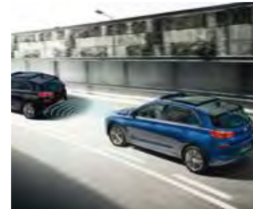
Adaptive Geschwindigkeitsregelanlage 1 : Hält einen festgelegten Abstand zum vorausfahrenden Fahrzeug ein und passt die Geschwindigkeit nach Bedarf an.
