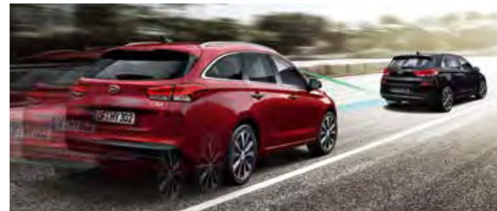
Autonomer Notbremsassistent mit Fußgängererkennung: stellt automatisch die maximale Bremskraft zur Verfügung, wenn eine potenzielle Kollision erkannt wird.
