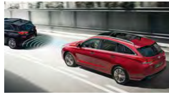
Adaptive Geschwindigkeitsregelanlage 1 : hält einen festgelegten Abstand zum vorausfahrenden Fahrzeug ein und passt die Geschwindigkeit nach Bedarf an.
