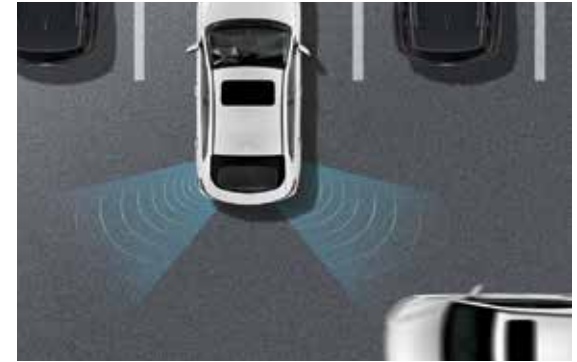
Querverkehrswarner, hinten. 1 Beim Zurücksetzen aus einem engen Parkplatz verringert der Querverkehrswarner das Risiko einer Kollision. Durch zwei Radarsensoren am Heck werden Sie im Falle von sich näherndem Querverkehr gewarnt.
