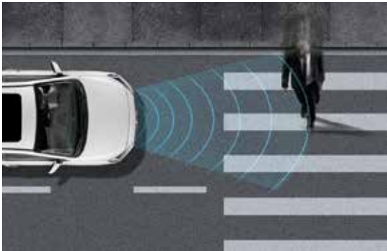
Autonomer Notbremsassistent inklusive Frontkollisionswarner und Fußgängererkennung (FCA). Das FCA-System überwacht mit Kamera und Radarsensor den vorausfahrenden Verkehr. Stellt der Notbremsassistent fest, dass eine Gefährdung durch andere Fahrzeuge (wenn Ihre Geschwindigkeit max. 180 km/h beträgt) oder für Fußgänger (wenn Ihre Geschwindigkeit max. 64 km/h beträgt) besteht, löst er zunächst eine optische und akustische Warnung aus und leitet im Notfall eine Teil- oder Vollbremsung ein, sofern Sie die Bremse nicht bereits selbst betätigt haben.
