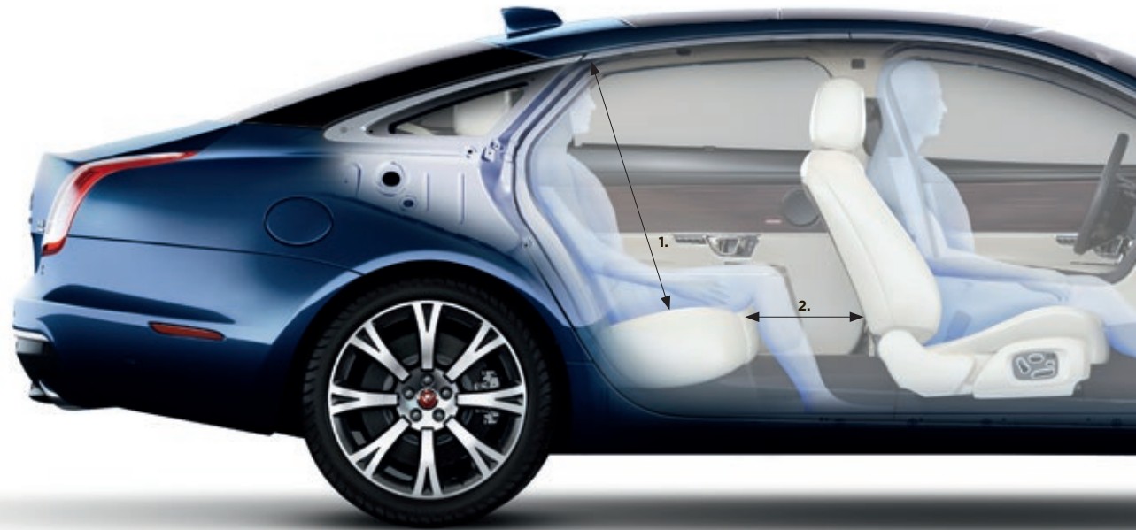
1. Langversion Kopffreiheit 960 mm 2. Langversion Kniefreiheit 189 mm
