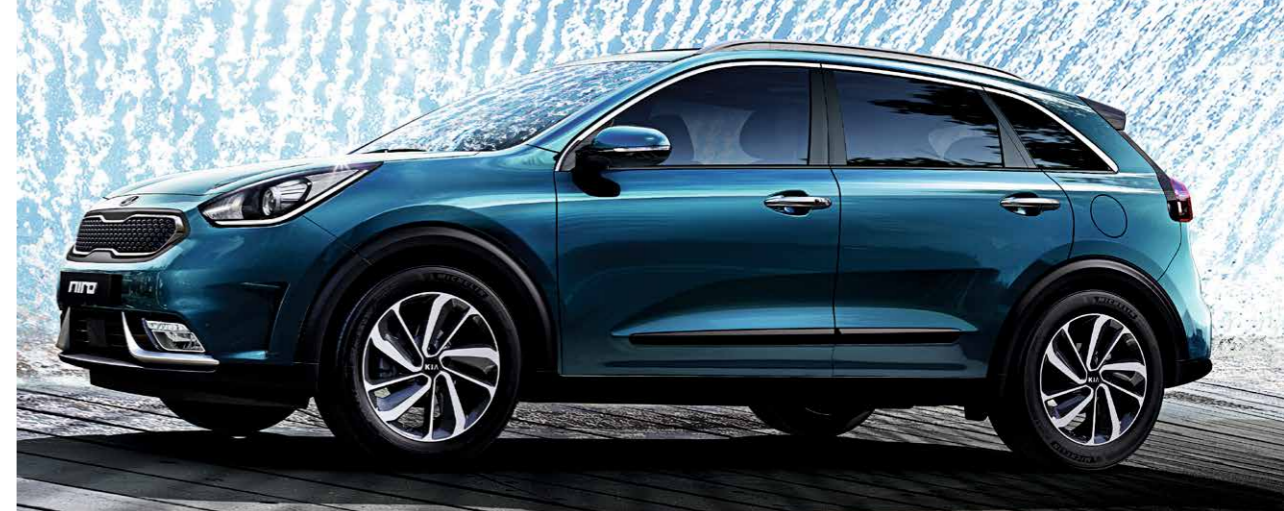
Eindrucksvolle Silhouette Die elegante Seitenansicht trägt nicht nur zur sportlichen Ausstrahlung des Kia Niro bei, sondern auch zu seiner hervorragenden Aerodynamik ( c_w -Wert 0,29).
