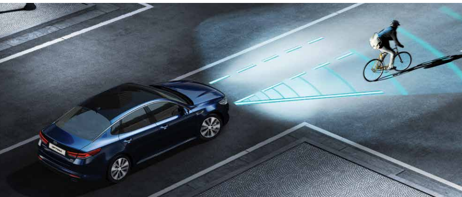
Dynamisches Kurvenlicht (DBL) Beim Abbiegen und in Kurven sorgt DBL (Dynamic Bending Light, Serie in SPIRIT) für eine bessere Ausleuchtung der Fahrbahn. Die automatische Leuchtweitenregulierung der Scheinwerfer verbessert zusätzlich die Lichtverhältnisse, indem sie Geschwindigkeit und Beladung des Fahrzeugs berücksichtigt.
