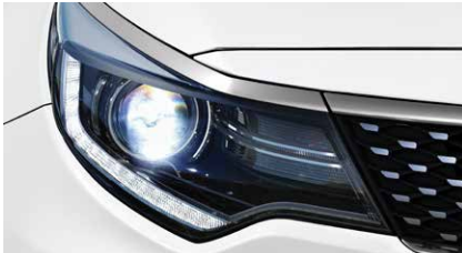
Xenonscheinwerfer mit LED-Tagfahrlicht und dynamischem Kurvenlicht (SPIRIT)
