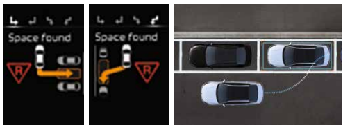
Intelligentes Parksystem (SPAS) Das SPAS (Smart Parking Assist System, optional für SPIRIT) beherrscht neben dem Einparken in parallel und quer zur Fahrbahn liegende Parklücken auch das parallele Ausparken – der Fahrer muss dabei nur noch Gas geben, bremsen und schalten.
