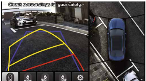
Rundumsichtkamera (AVM) Mit den Bildern von vier Kameras an Front, Heck und beiden Seiten erzeugt AVM (Around View Monitor, optional für SPIRIT) bei Geschwindigkeiten von unter 20 km/h eine Fahrzeugansicht aus der Vogelperspektive, die das Manövrieren erleichtert.
