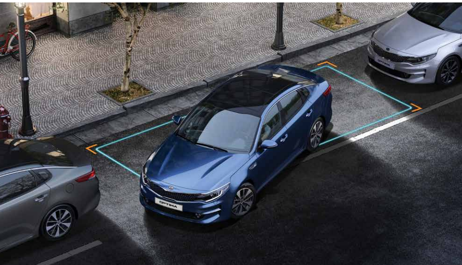
Rundumsichtkamera (AVM) Mit den Bildern von vier Kameras an Front, Heck und beiden Seiten erzeugt AVM (Around View Monitor, optional für SPIRIT) bei Geschwindigkeiten von unter 20 km/h eine Fahrzeugansicht aus der Vogelperspektive, die das Manövrieren erleichtert.
