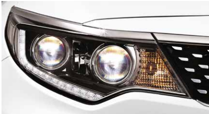
Projektionsscheinwerfer mit LED-Tagfahrlicht und statischem Abbiegelicht (VISION)
