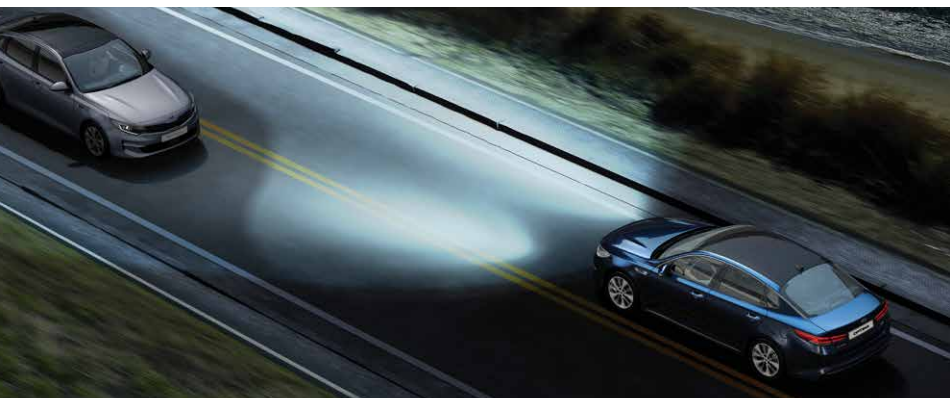
Fernlichtassistent (HBA) Per Kamera erkennt HBA (High Beam Assist, Serie in SPIRIT) entgegenkommende und vorausfahrende Fahrzeuge. Das System blendet dann automatisch ab – und wieder auf, sobald die Verkehrssituation es zulässt.
