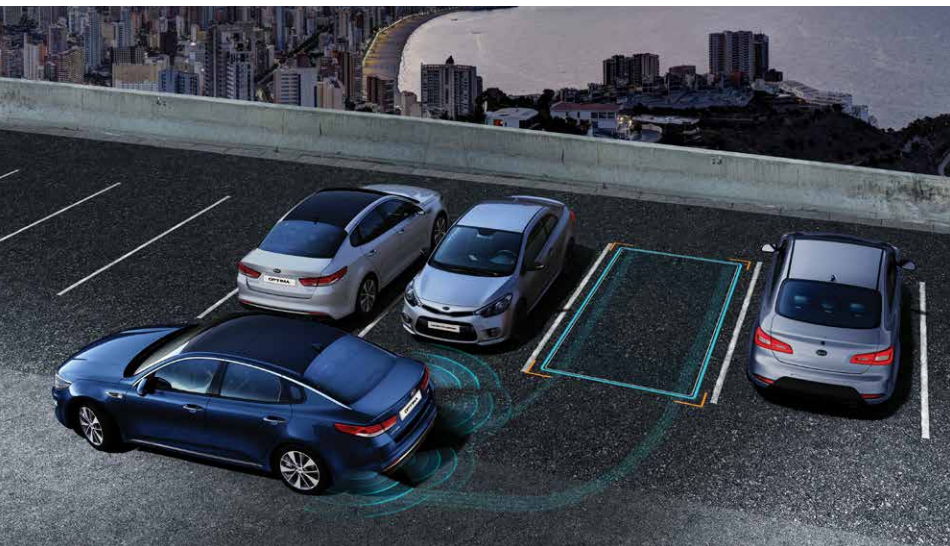
Intelligentes Parksystem (SPAS) Das SPAS (Smart Parking Assist System, optional für SPIRIT) beherrscht neben dem Einparken in parallel und quer zur Fahrbahn liegende Parklücken auch das parallele Ausparken – der Fahrer muss dabei nur noch Gas geben, bremsen und schalten.
