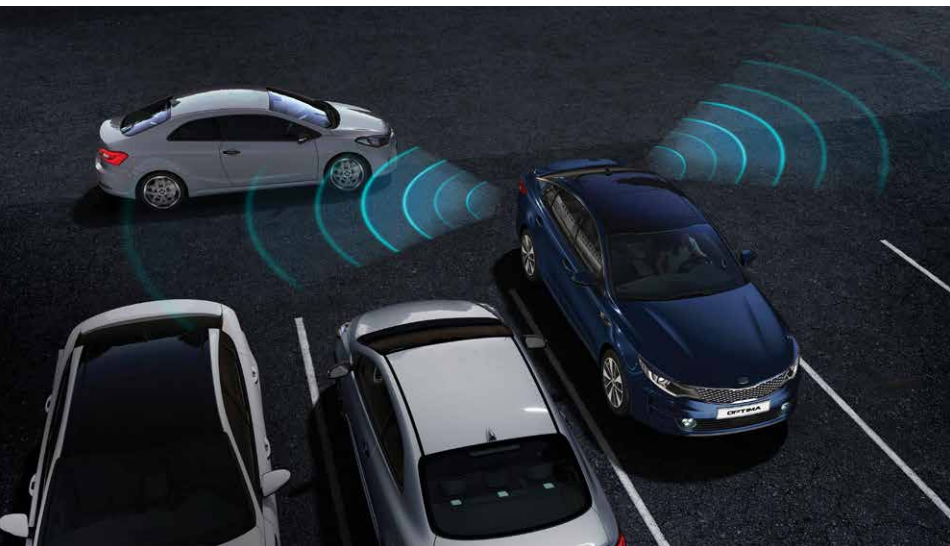
Querverkehrswarner (RCTA) Beim Rückwärtsfahren aus Parklücken oder Einfahrten warnt RCTA (Rear Cross Traffic Alert, optional für SPIRIT) den Fahrer vor Fahrzeugen, die seinen Weg kreuzen.
