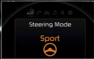
Flex Steer™ Die Modelle mit Schaltgetriebe verfügen über die variable Servolenkung Flex Steer™. Mit dem zweistufigen System (Normal/Sport) lässt sich die Lenkunterstützung je nach Fahrsituation anpassen – um zum Beispiel möglichst komfortabel einzuparken oder bei sportlichen Kurvenfahrten eine sehr direkte Rückmeldung zu erhalten.
