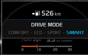
Drive Mode Select Beim Automatikmodell lässt sich durch das System „Drive Mode Select“ der Fahrmodus variieren. Der Fahrer kann zwischen vier Einstellungen wählen: „Normal“, „Eco“ für eine spritsparende Fahrweise, „Sport“ für ein besonders dynamisches Fahren und „Smart“, bei dem der Wagen eigenständig die optimalen Einstellungen wählt.
