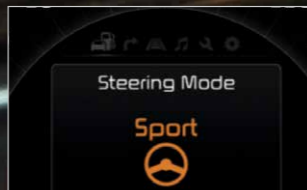
Flex Steer™ Die Modelle mit Schaltgetriebe verfügen über die variable Servolenkung Flex Steer™. Mit dem zweistufigen System (Normal/Sport) lässt sich die Lenkunterstützung je nach Fahrsituation anpassen – um zum Beispiel möglichst komfortabel einzuparken oder bei sportlichen Kurvenfahrten eine sehr direkte Rückmeldung zu erhalten.
