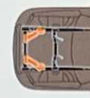
Zwei Aufgaben übernehmen die beiden neuen Rahmenwinkel: Sie versteifen die Radaufhängung und leiten bei einem Aufprall die Energie in geordnete Bahnen.
