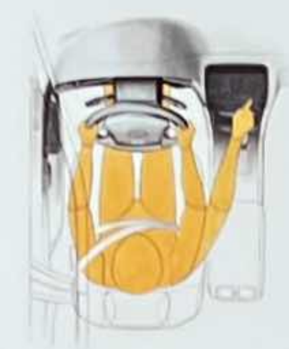
Die wesentlichen Bedienelemente befinden sich alle in der Reichweite des Fahrers.
