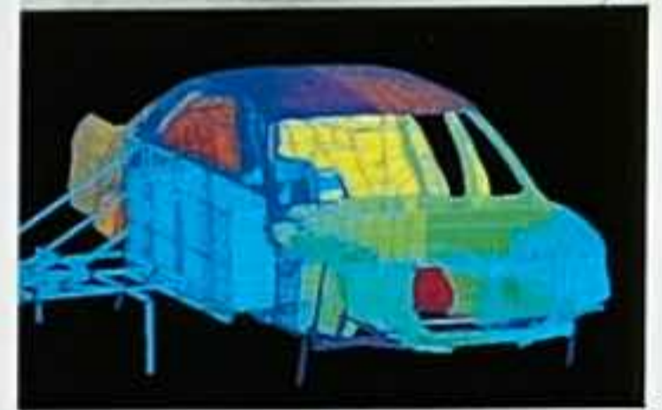
Wo die Praxis an die Grenzen des Meßbaren stieß, setzte der Kollege Computer die Forschung fort: Mit den Daten, die aus Versuchsreihen gewonnen wurden, konnte der Energieabbau über die Karosseriestruktur perfekt kontrolliert und optimiert werden.
