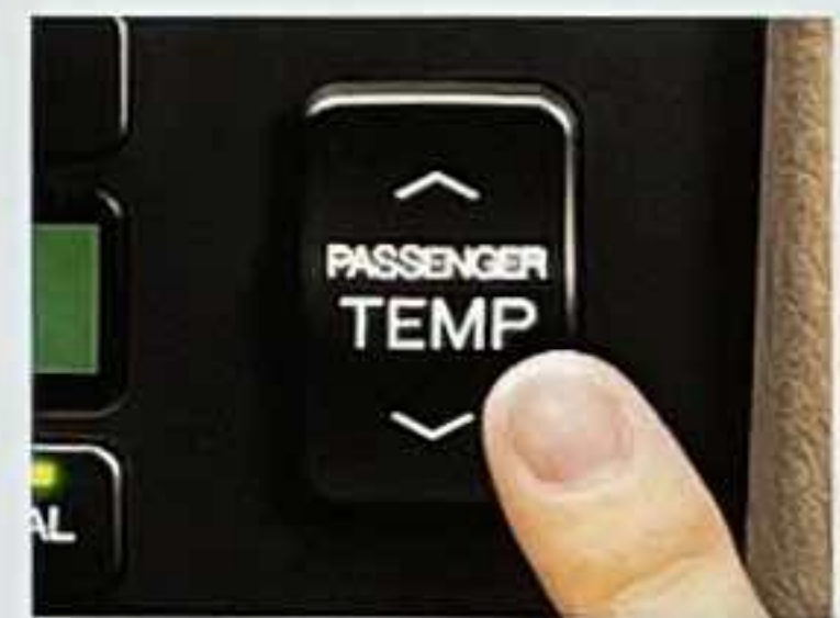
Häufig benutzte Schalter, wie beispielsweise der Temperaturregler der Klimaautomatik oder der Lautstärkereglere der Audio-Anlage, sind gezielt darauf ausgelegt, daß sie „blind“ bedient werden können.
