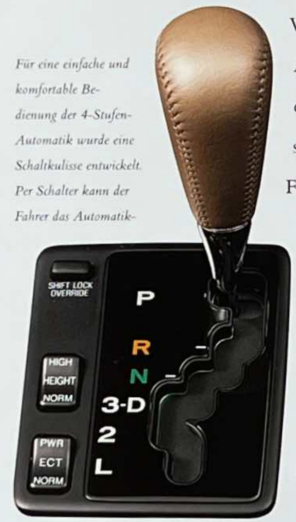
getriebe auf normale oder sportliche Charakteristik einstellen und die auf Wunsch erhältliche Niveauregulierung aktivieren.
