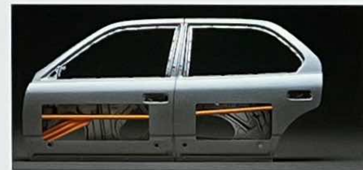
Auch der herkömmliche Seitenaufprallschutz wurde überdacht: In seiner neuen Form nimmt er nicht nur die Aufprallenergie auf, sondern leitet sie auch in die gesamte Karosseriestruktur ab.
