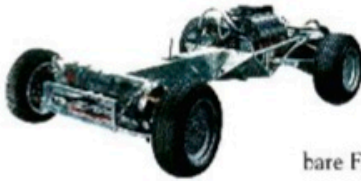
Das außergewöhnlich solide, feuerverzinkte Stahlchassis mit Motor.
