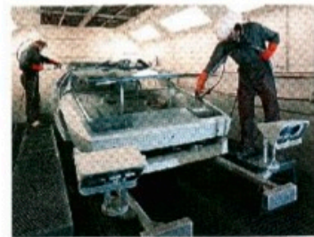
Die Karosserie eines jeden Wagens wird zusammen mit den Anbauteilen von erfahrenen Technikern sprühlackiert, damit die Tönungen perfekt stimmen.
