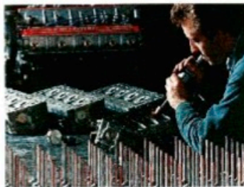
Lotus Motoren werden so präzise gebaut, daß jedes Ventil mit der Hand wird, damit es auch genau paßt.
