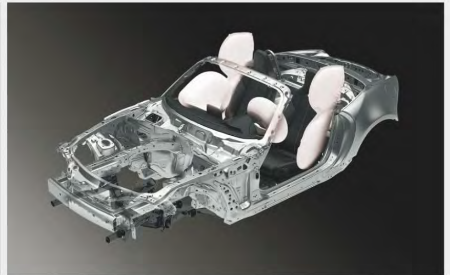
KAROSSERIE: LEICHTE UND HOCHFESTE STRUKTUR FÜR HOHE CRASH-SICHERHEIT UND AGILES HANDLING
