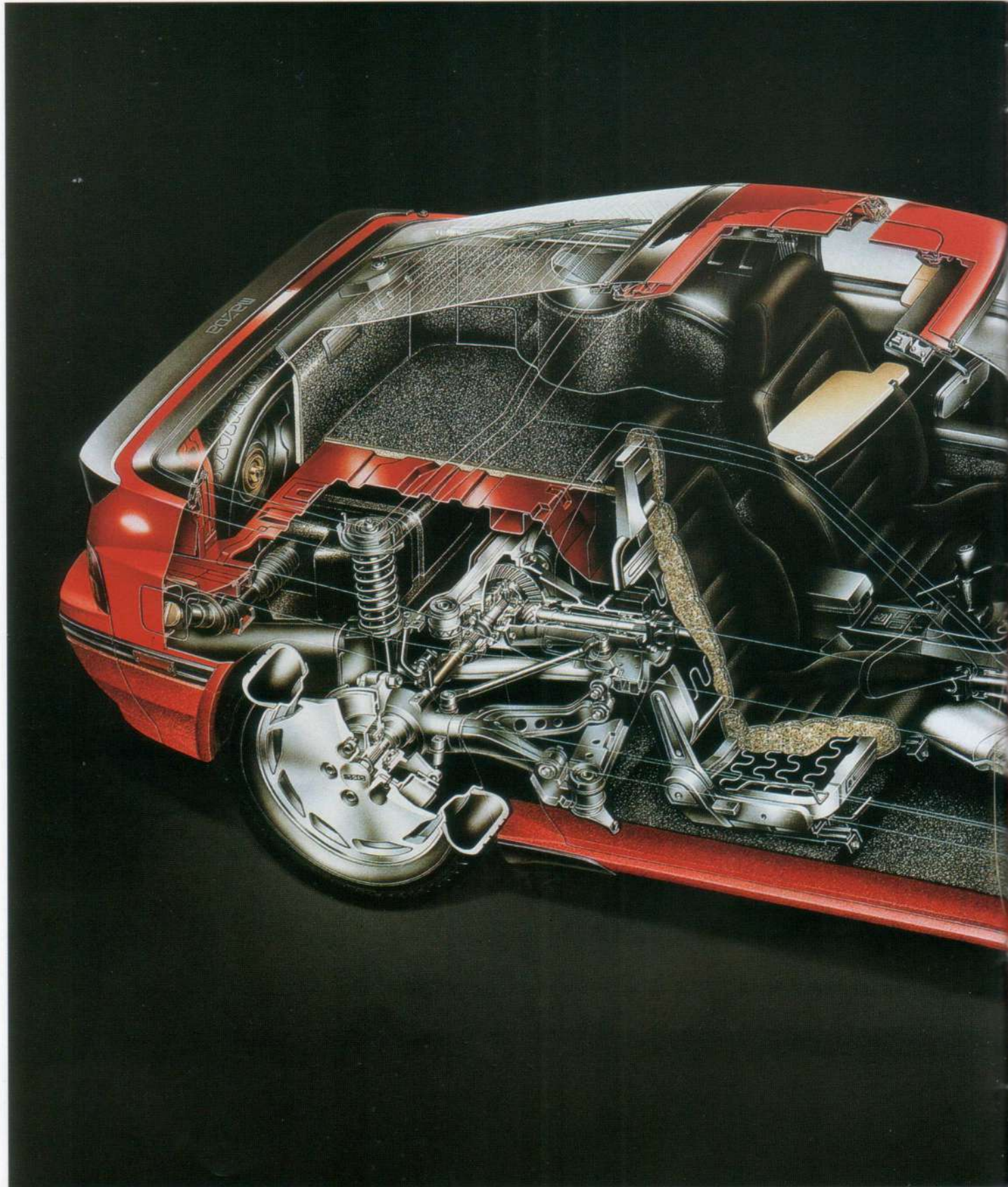
Schnittmodell Mazda RX-7 mit S-Paket
