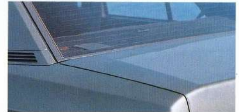
Aerodynamisch: hoch angesetzte Abrißkante am Heck.
