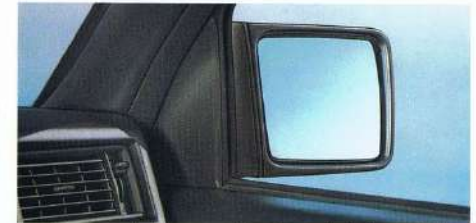
Nach vorn und hinten umklappbarer beheizter Außenspiegel; rechter Außenspiegel Sonderausstattung.
