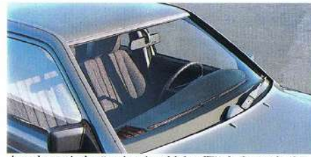
Aerodynamisch günstig: eingeklebte Windschutzscheibe.
