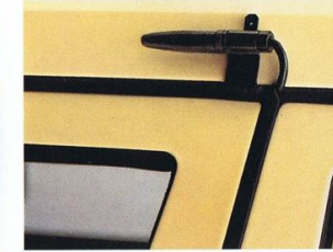
Steckkontakt für die Dachzeichenbeleuchtung.
