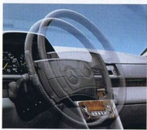
Ebenfalls auf Wunsch: Das Lenkrad kann stufenlos elektrisch in der Längsrichtung angepaßt werden.
