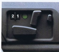
Die elektrische Sitzverstellung (auf Wunsch), auch mit Memory-Speicherung für zwei Sitzpositionen.
