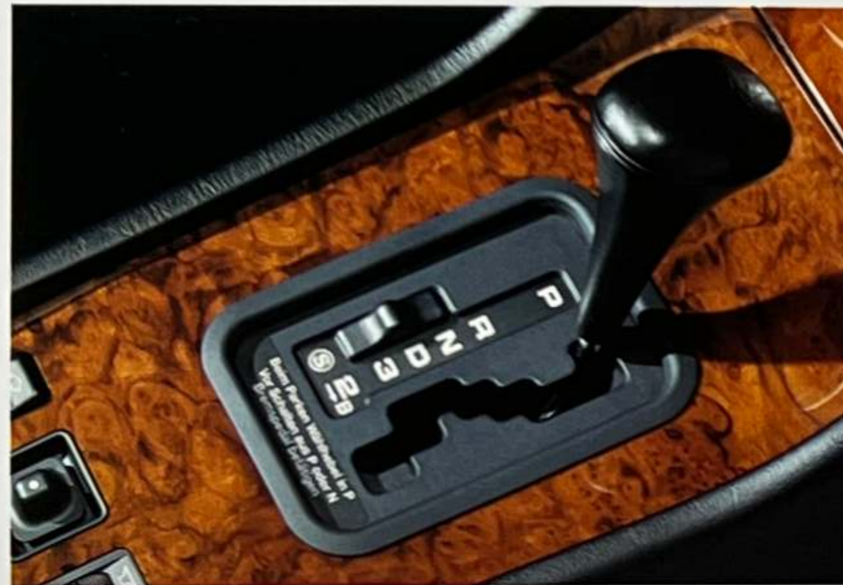
Die serienmäßige 4-Gang-Automatic verfügt über zwei Fahrprogramme. S wie sportlich und E wie Economy. Die Beleuchtung der Wählhebelkulisse informiert Sie über die eingelegte Fahrstufe.
