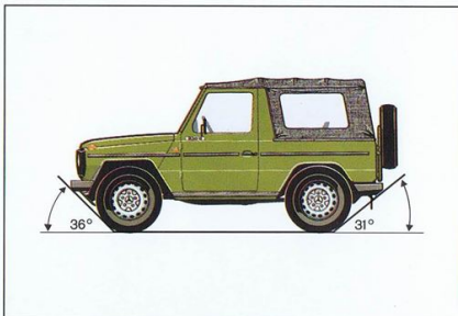
Radstand und Aufbauabmessungen ergeben große Überhangwinkel.
