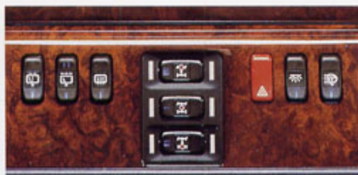
Alles in Reichweite: alle wichtigen Schalter inklusive der Differentialsperrenschalter sind gut erreichbar.
