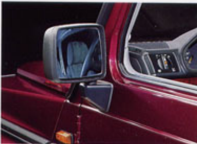
Klare Sicht: der heizbare, asphärische Rückspiegel ist elektrisch einstellbar.
