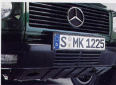
Sichere Sache: der Motoraufsetzschutz und der neue Stofffänger; beim Diesel mit integriertem Ladeluftkühler.
