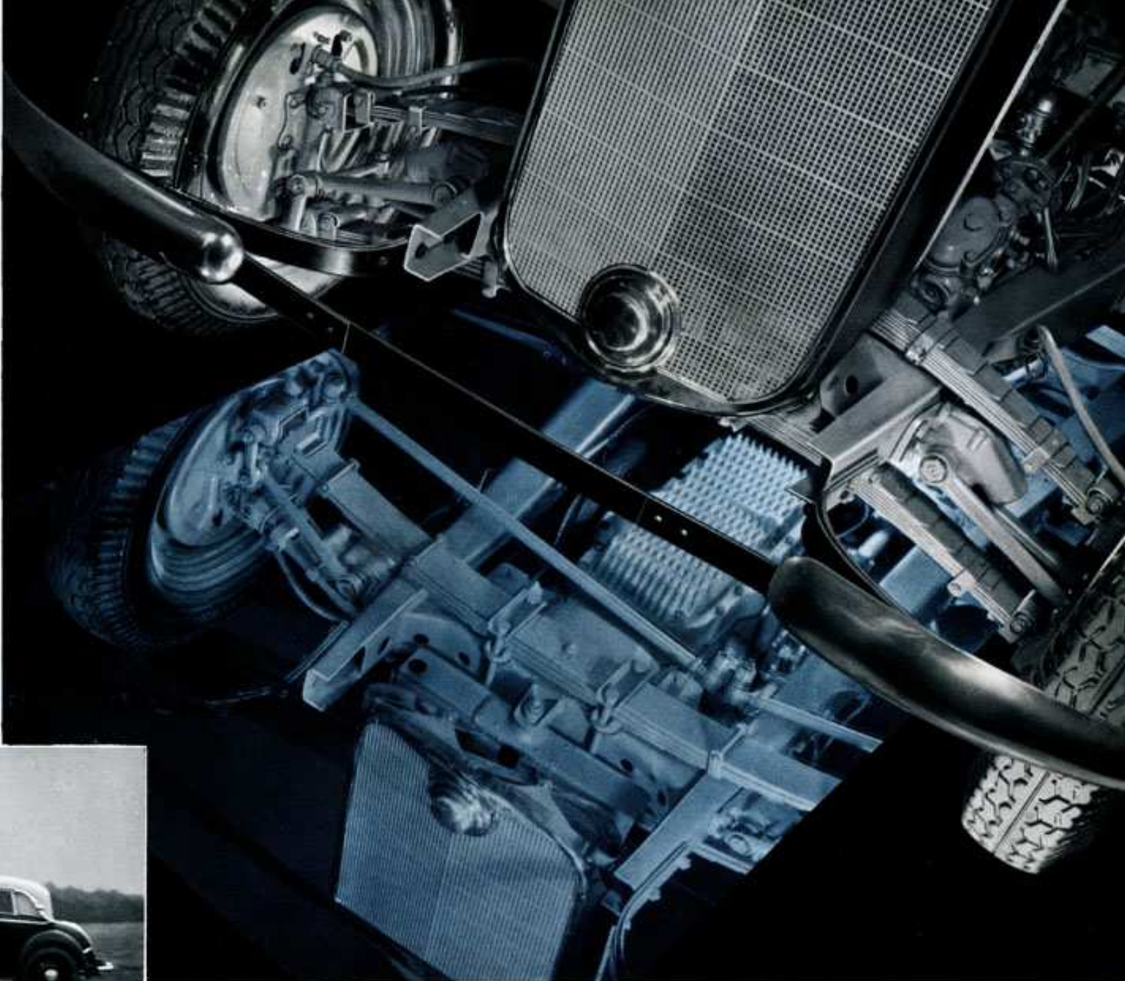
Dieses Bild zeigt die beiden kräftigen Blattfederpakete, an deren Enden die Vorderräder aufgehängt sind. Im Spiegelbild erkennt man die hydraulischen Stoßdämpfer, die Ölleitung der hydraulischen Öldruckbremse und die beiden Spurstangen der Einzelradlenkung.
