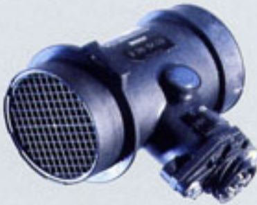
Der Heißfilm-Luftmassenmesser optimiert das Kraftstoff-Luft-Gemisch.
