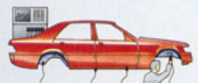
Elektronisch gesteuerte Hohlraumkonservierung
