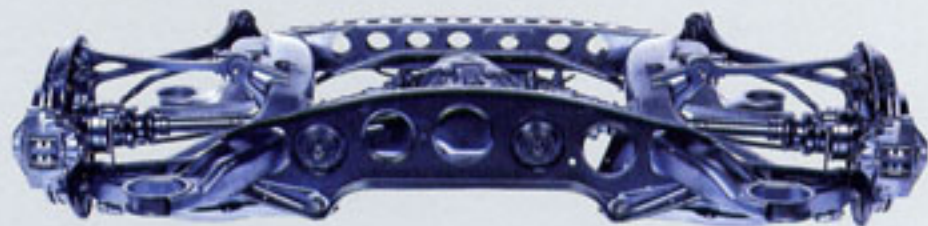
Die Doppelquerlenker-Vorderachse sorgt für ein besseres Fahrverhalten.
