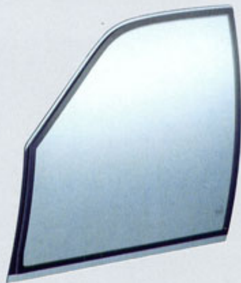
Das erste Mal in einem Pkw: die doppelte Seitenverglasung.
