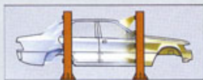
Entfetten und Phosphatisieren
