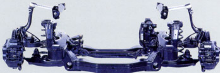
Die Doppelquerlenker-Vorderachse sorgt für ein besseres Fahrverhalten.
