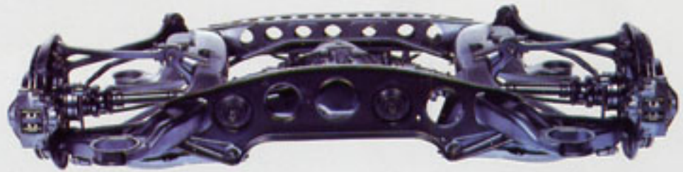
Die Raumlenker-Hinterachse unterbindet unerwünschte Eigenlenkeffekte und hält das S-Klasse Coupé optimal auf Kurs.
