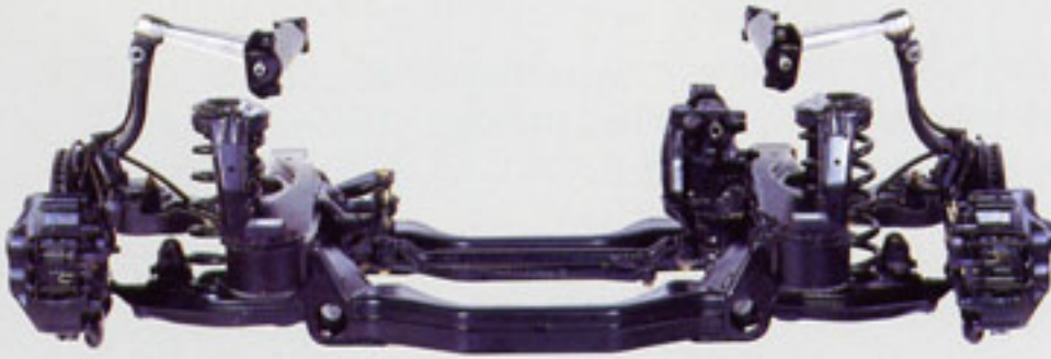
Die Doppelquerlenker-Vorderachse sorgt für eine noch ruhigere Fahrt.
