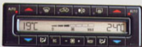
2 Klimazonen unter einem Dach: die Klimatisierungsautomatik im S 600.
