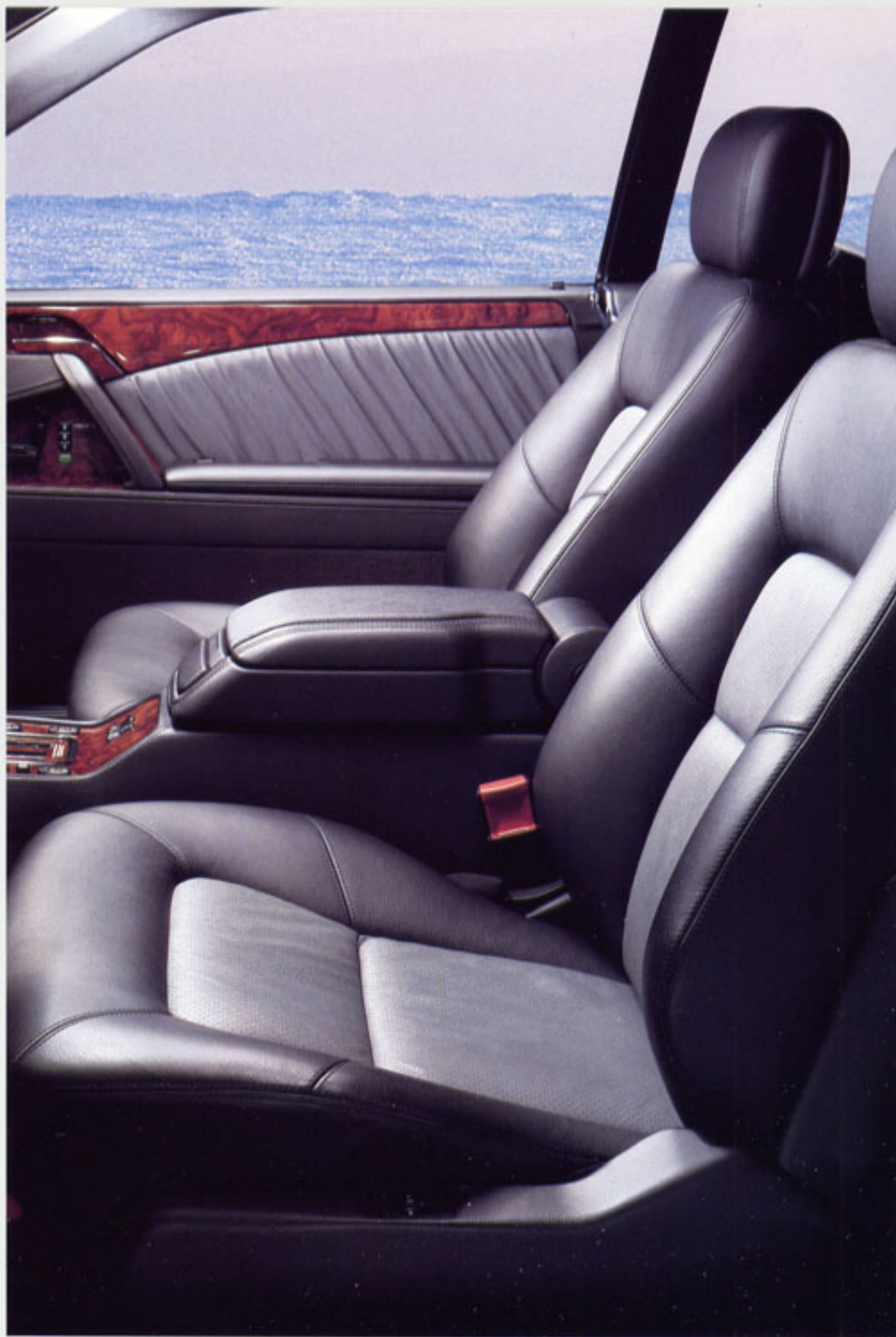
Die Vordersitze haben ausgeprägten Schalencharakter, und ihre Lehnen sind mit einer Lendenstütze ausgestattet.
