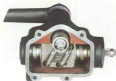
Exakte, selbstnachstellende leichtgängige Kugelumlauf-Lenkung mit Lenkungsstoßdämpfer
