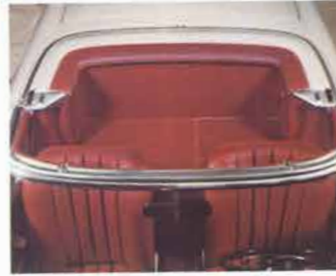
Roadsterverdeck vollständig versenkt und durch Metall-Blende geschützt
