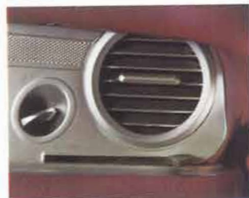
Große Lufteintrittsöffnungen mit stufenlos verstellbarem Luftstrom
